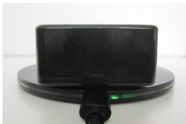
LED-Statusanzeige (grün): das RobiCare®-Geräte-Modul ist aufgeladen.
